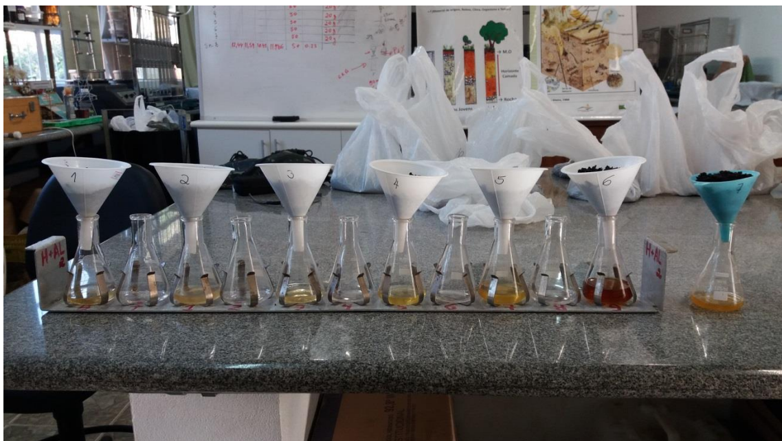
Figura 2: Drenagem das amostras de substratos para aferição da capacidade de retenção de água.
